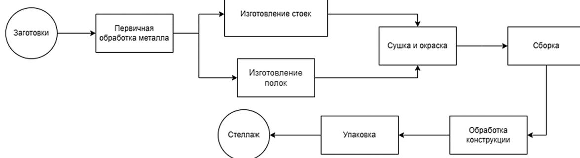
Рисунок 1 – Обобщенная структура технологического процесса изготовления стеллажного оборудования
